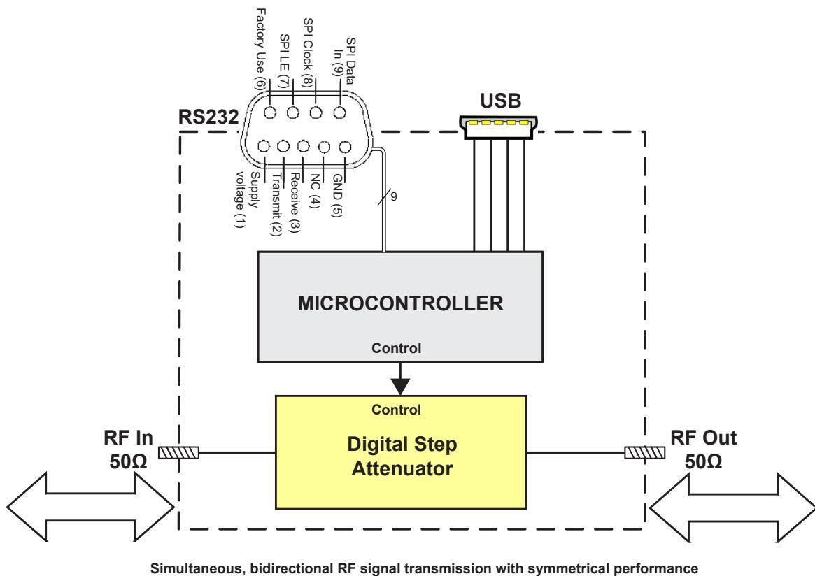
**\*9 Pin D-Sub Pin Connections**
