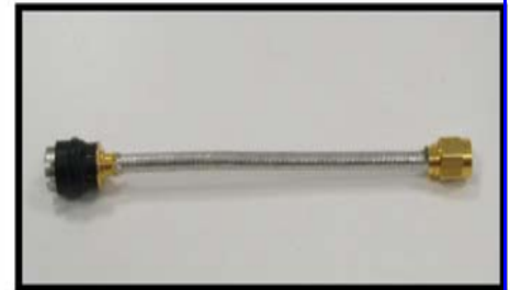
Fig. 3 DUT Test Cable
