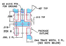
NOTES: 1. TRACE WIDTH IS SHOWN FOR ROGERS RO4350B WITH DIELECTRIC THICKNESS 0.020" ± 0.0015"; COPPER: 1/2 OZ. EACH SIDE. FOR OTHER MATERIALS TRACE WIDTH MAY NEED TO BE MODIFIED. 2. BOTTOM SIDE OF THE PCB IS CONTINUOUS GROUND PLANE.
