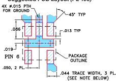
NOTES: 1. TRACE WIDTH IS SHOWN FOR ROGERS RO4350B WITH DIELECTRIC THICKNESS 0.020" ± 0.0015"; COPPER: 1/2 0Z. EACH SIDE. FOR OTHER MATERIALS TRACE WIDTH MAY NEED TO BE MODIFIED. 2. BOTTOM SIDE OF THE PCB IS CONTINUOUS GROUND PLANE.
