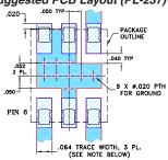
NOTES: 1. TRACE WIDTH IS SHOWN FOR ROGERS RO43508 WITH DIELECTRIC THICKNESS. 0.30° ± .002°; COPPER: 1/2 02. EACH SIDE. FOR OTHER MATERIALS TRACE WIDTH MAY NEED TO BE MODIFIED. 2. BOTTOM SIDE OF THE PCB IS CONTINUOUS GROUND PLAME. DENOTES PCB COPPER LAVOUT WITH SMOSC (SOLDER MASK OVER BARE COPPER)
