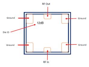
Fig 2. Die Layout Note: Alternate Die ID: ATN3590\_12
