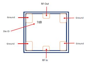
Fig 2. Die Layout Note: Alternate Die ID: ATN3590\_07
