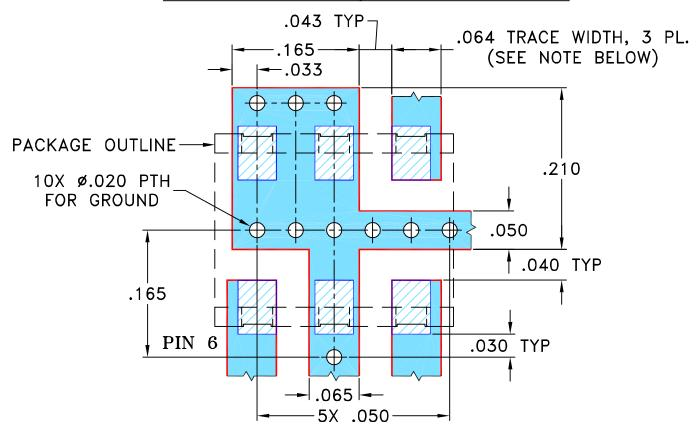
NOTES: 1.TRACE WIDTH IS SHOWN FOR ROGERS RO4350B WITH DIELECTRIC THICKNESS 0.030" ± 0.002"; COPPER: 1/2 OZ. EACH SIDE. FOR OTHER MATERIALS TRACE WIDTH MAY NEED TO BE MODIFIED. 2.BOTTOM SIDE OF THE PCB IS CONTINUOUS GROUND PLANE.
