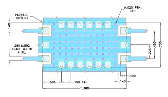
NOTES: 1. TRACE WIDTH IS SHOWN FOR OAK-602, WITH DIELECTRIC THICKNESS .022"±.0015". COPPER: 1/2 Oz. EACH SIDE. FOR OTHER MATERIALS TRACE WIDTH MAY NEED TO BE MODIFIED. 2. BOTTOM SIDE OF THE PCB IS CONTINUOUS GROUND PLANE. DENOTES PCB COPPER LAYOUT WITH SMOBC (SOUDED MASK OVER BARE COPPER) (SOLDER MASK OVER BARE COPPER)
