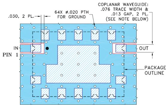
NOTE: 1. COPLANAR WAVEGUIDE PARAMETERS ARE SHOWN FOR ROGERS RO4350B WITH DIELECTRIC THICKNESS  $.060" \pm .004"$ ; COPPER: 1/2 OZ. EACH SIDE.
