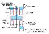
NOTES: 1. TRACE WIDTH IS SHOWN FOR ROGERS RO4350B WITH DIELECTRIC THICKNESS 0.020"  $\pm$  0.0015"; COPPER: 1/2 OZ. EACH SIDE. FOR OTHER MATERIALS TRACE WIDTH MAY NEED TO BE MODIFIED. 2. BOTTOM SIDE OF THE PCB IS CONTINUOUS GROUND PLANE.
