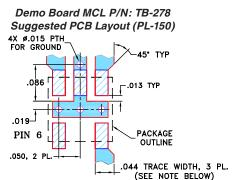
NOTES: 1. TRACE WIDTH IS SHOWN FOR ROGERS RO4350B WITH DIELECTRIC THICKNESS 0.020" ± 0.0015"; COPPER: 1/2 OZ. EACH SIDE. FOR OTHER MATERIALS TRACE WIDTH MAY NEED TO BE MODIFIED. 2. BOTTOM SIDE OF THE PCB IS CONTINUOUS GROUND PLANE.
