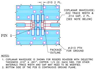
DENOTES PCB COPPER LAYOUT WITH SMOBC (SOLDER MASK OVER BARE COPPER).
