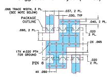
NOTES: 1. TRACE WIDTH IS SHOWN FOR ROGERS RO4350B WITH DIELECTRIC THICKNESS. 0.30" ± 0.02"; COPPER: 1/2 0.2. EACH SIDE. FOR OTHER MATERIALS TRACE WIDTH MAY NEED TO BE MODIFIED. 2. BOTTOM SIDE OF THE POB IS CONTINUOUS GROUND PLANE.
