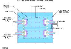
1. TRACE WIDTH IS SHOWN FOR ROGERS(R04350B) WITH DIELECTRIC THICKNESS .030°±.002°. COPPER: 1/2 02. EACH SIDE. FOR OTHER MATERIALS TRACE WIDTH MAY NEED TO BE MODIFIED. 2. BOTTOM SIDE OF THE PCB IS CONTINUOUS GROUND PLANE.
