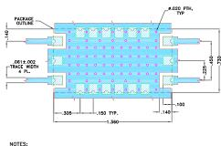
ES: TRACE WIDTH IS SHOWN FOR OAK-602, WITH DIELECTRIC THICKNESS .022\*4.0015\*. COPPER: 1/2 02. EACH SIDE. FOR OTHER MATERIALS TRACE WIDTH MAY NEED TO BE MODIFIED. BOTTOM SIDE OF THE PCB IS CONTINUOUS GROUND PLANE. DENOTS PCB COPPER LAYOUT WITH SMOBE (SOLDER MASK OVER BARE COPPER) DENOTES COPPER LAND PATTERN FREE OF SOLDERMASK
