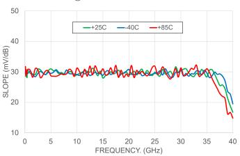
SLOPE Vs FREQUENCY OVER TEMPERATURE RANGE
